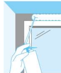
Aplicació de material aïllant
