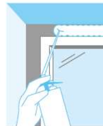
Aplicació de material aïllant
