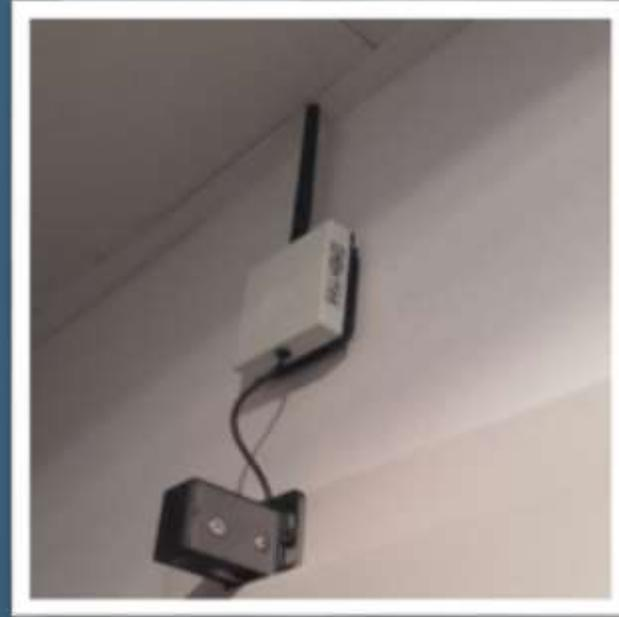
**Contador de acceso en baño: adapta la frecuencia de limpieza al uso real**
