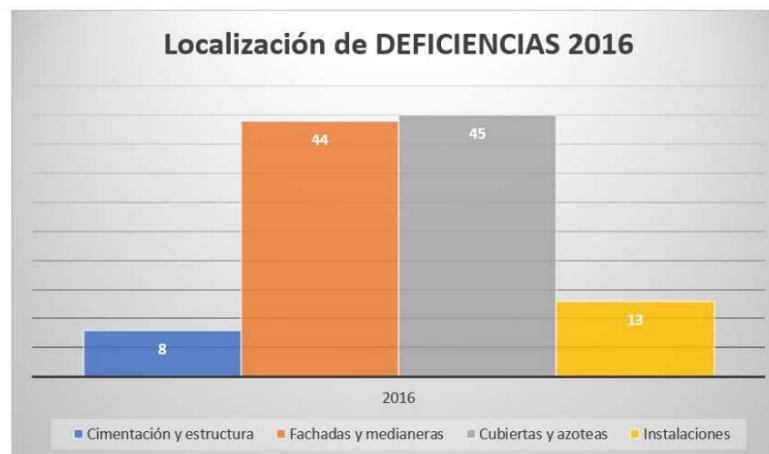
Gráfico 14. Localización de las deficiencias de las inspecciones desfavorables 2016. Fuente: CAATEEB con los datos del Observatorio ITE
